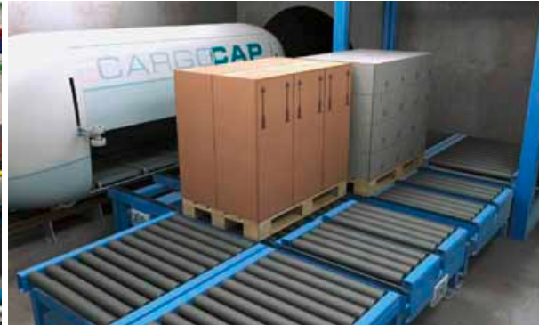
Die Caps werden mit jeweils zwei Euro-Paletten bestückt. Damit ist das CargoCap-System voll in die Warenlogistik integrierbar
